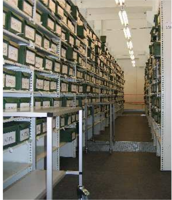
Et godt arkivlokale. Alle sager står i reoler, der er løftet lidt fra gulvet. Der er ingen vandrør eller el-installationer, og der er tørt og rent.
